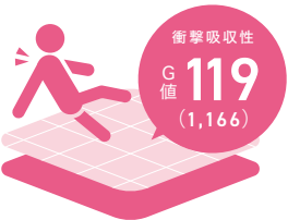
■衝撃吸収性試験 JIS A 6519 「体育館用鋼製床下地構成材」 床の硬さ試験
