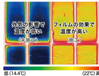
外気温6°Cの環境下で20°Cの暖房をつけた際、フィルム施工したガラス表面は室内の暖かさを保っている。
