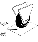
タイヤ等のゴム製品が床材と接する際は保護シート(アルミ製・ポリエステル製)をご使用ください。
